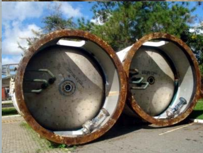
IMGs 176-177-178 Material Predominante: Al 316. Reatores com agitador Motor: 130 CV Redutor: TT - 1: 22 Serpentina interna em aço inox Diâmetro 3.600mm, altura 8400mm, chapa do costado 14 mm Temperatura de trabalho até 120°C Quantidade:2. Peso: 25.000Kg cada
