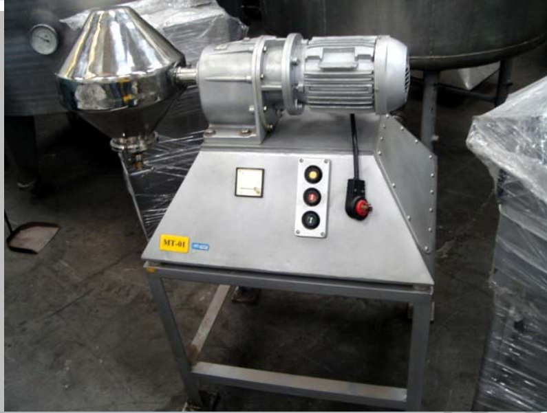
IMG 101 Tipo: misturador duplo cone Motor: WEG
